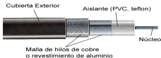
Figura 4.1.2.98 Estructura del cable coaxial.
